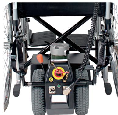
**Der EasyGo Rehab Holiday ist ein von der Begleitperson gesteuerter Hilfsmotor, der die Flexibilität und Mobilität des Rollstuhlfahrers erhöht und zugleich die Begleitperson bei Ausflügen und während Ferien entlastet.**
